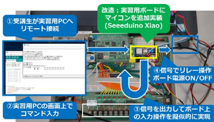
図4. 遠隔から実習用ボードを操作するための手順
