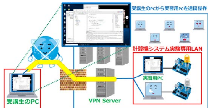
図2. リモート実習作業システムの構成
